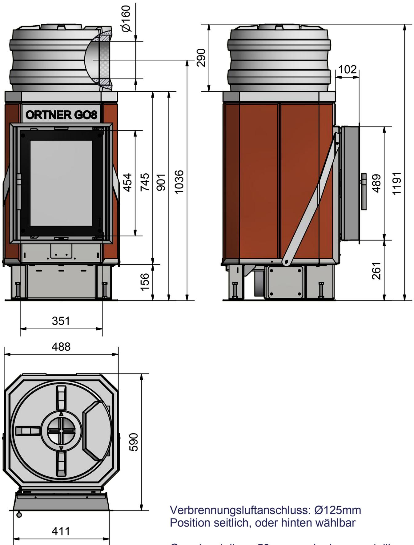
Verbrennungsluftanschluss:  $\varnothing 125\text{mm}$
